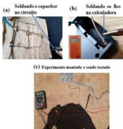
Figura 3 — Montagem do circuito elétrico, experimento denominado “placa solar de LEDs”. Em (a) momento da soldagem do capacitor no circuito. Em (b) mostra a soldagem dos fios na calculadora. Em (c) mostra o experimento completamente montado sendo testado.
