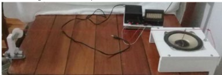
Figura 1: reconstrução do oscilador de Franz Melde.
