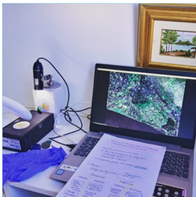
Figura 3: Recursos didáticos utilizados em uma aula virtual, com destaque para o microscópio com zoom de 1600x, acoplado ao notebook via entrada USB, em uma aula sobre pigmentos. Material analisado: mineral de malaquita, utilizado para a produção de pigmento verde desde a Antiguidade até o século XVI. (Fonte: própria autora, 2020).
